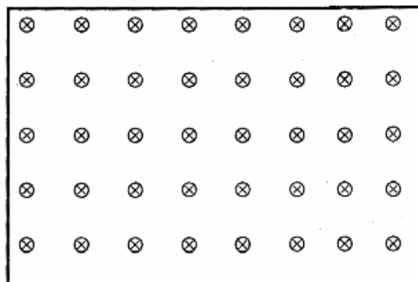
Hình 9: Vị trí các điểm chói và điểm màu theo dạng tỷ lệ 4.4:4
