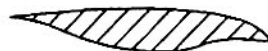
Hình 10 – Profin thử nổ chấp nhận được – Không rẽ nhánh theo chiều dọc
