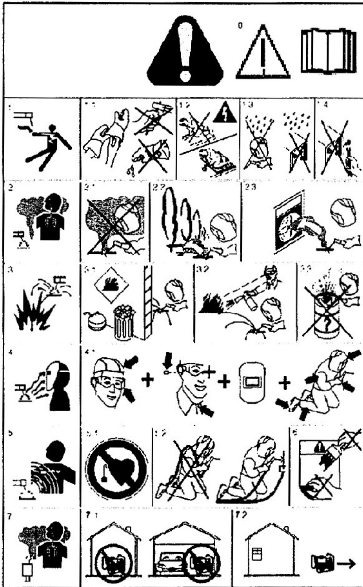
Hình C.1 – Ví dụ về nhãn phòng ngừa cho nguồn điện hàn hồ quang kim loại thủ công truyền động bằng động cơ đốt trong
