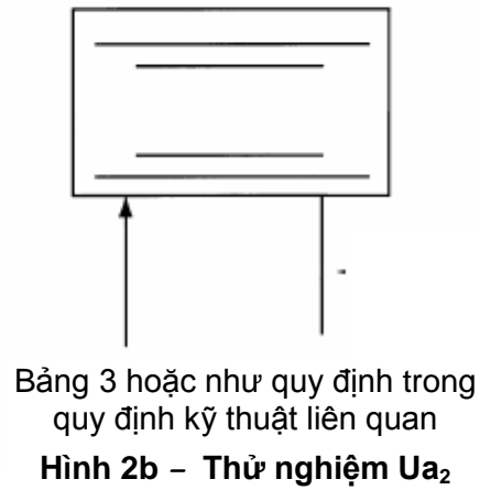
Hình 2 - Phác thảo thể hiện hướng đặt lực bằng mũi tên Thử nghiệm U_{a1} : kéo và thử nghiệm U_{a2} : đẩy
