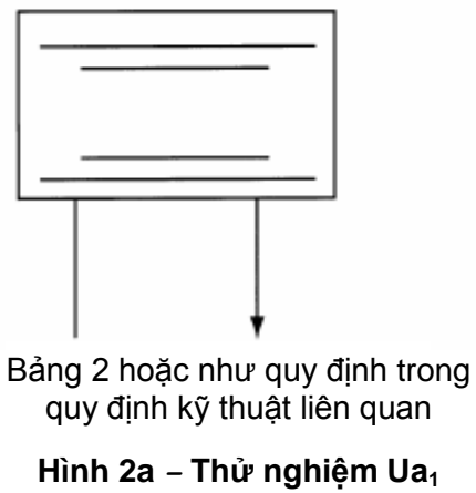
Hình 2 - Phác thảo thể hiện hướng đặt lực bằng mũi tên Thử nghiệm U_{a1} : kéo và thử nghiệm U_{a2} : đẩy
