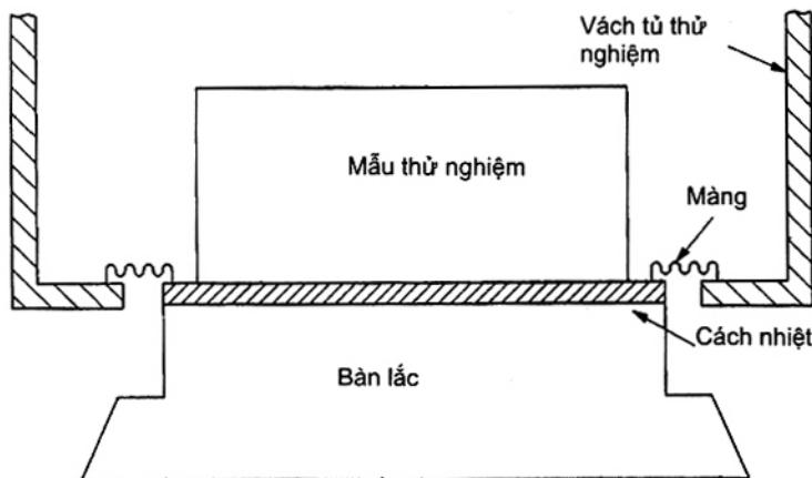
**Hình B.1 – Ví dụ đối với kiểu đặt thử nghiệm**
