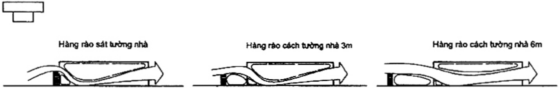
a) Hàng rào sát tường nhà, hoặc cách nhà 3 m, hoặc cách nhà 6 m.
