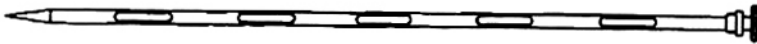
Hình B.2 - Xiên trục mở có nhiều lỗ hoặc trục đóng có các ngăn chứa
