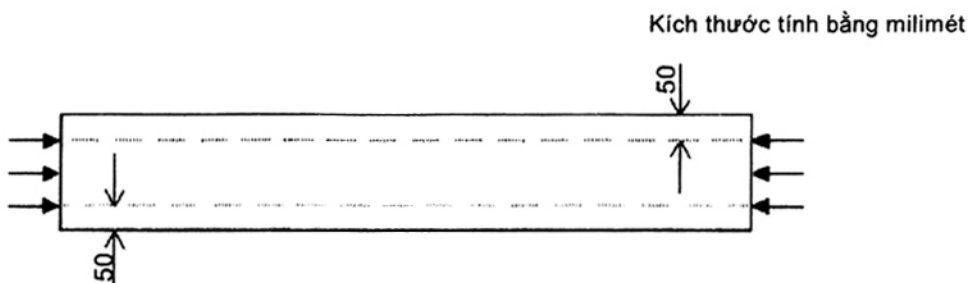
Hình 1 - Cách đo chiều dài tấm xi măng sợi
