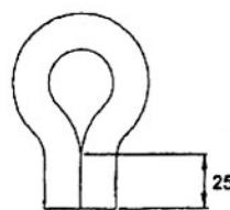
Hình 103 – Tạo hình ống mềm để xử lý đông lạnh
