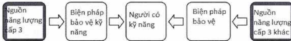
[Hình 19] – Mô hình cho bảo vệ người có kỹ năng khỏi nguồn năng lượng cấp 3 đang trong điều kiện bảo dưỡng thiết bị
